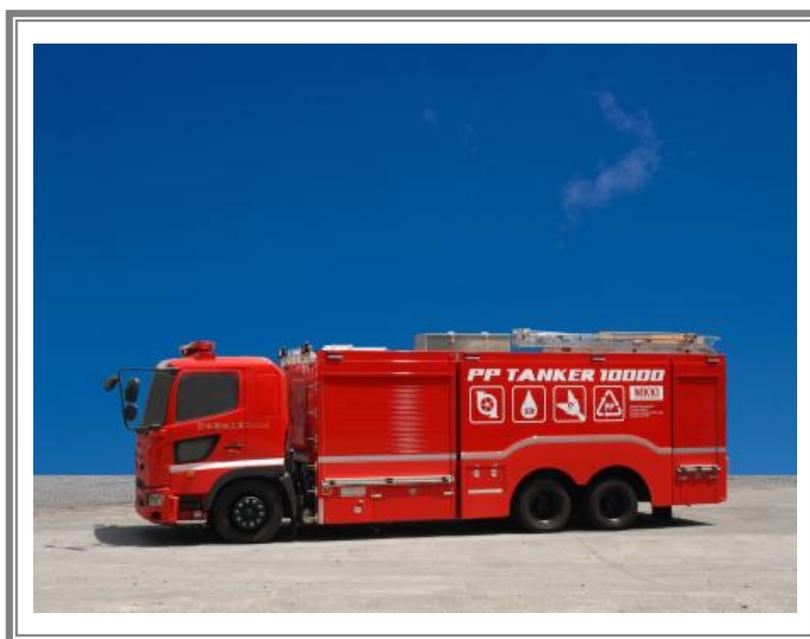
“PP TANKER 10000” は従来の楕円形タンクと比較し、角型を採用することによるスペース効率を活かし積載品や車両寸法へのニーズに対応する事が可能となっております。
