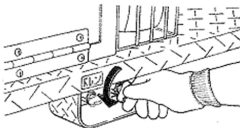
水槽ドレンバルブ「開」操作
