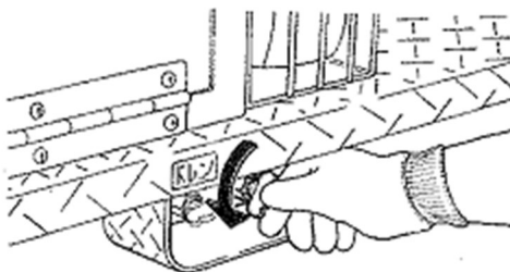
泡原液槽ドレンバルブ「開」操作
