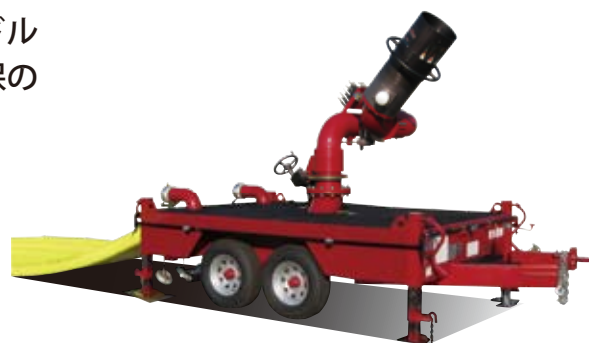
滑り止め加工デッキ 車体固定用ジャッキ ×4
