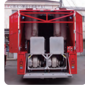
▲高揚程の油圧式水中ポンプ 2基で毎分 25000Lの水を送水ポンプに送り込みます。
